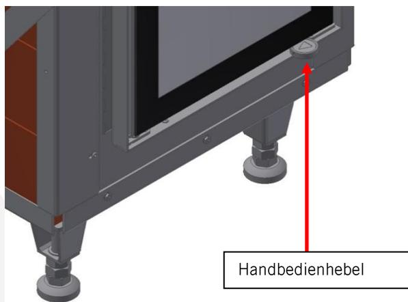
Der Bedienhebel ist in seiner Funktion gekennzeichnet.
